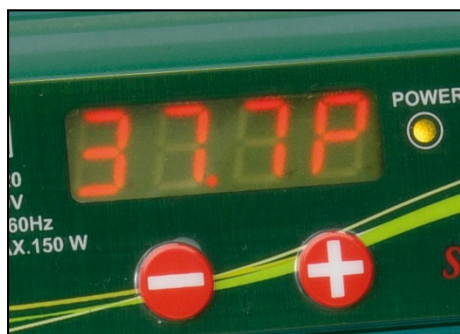
Экран, на котором отображается температура в режиме программирования (рядом со значением температуры стоит "P")
